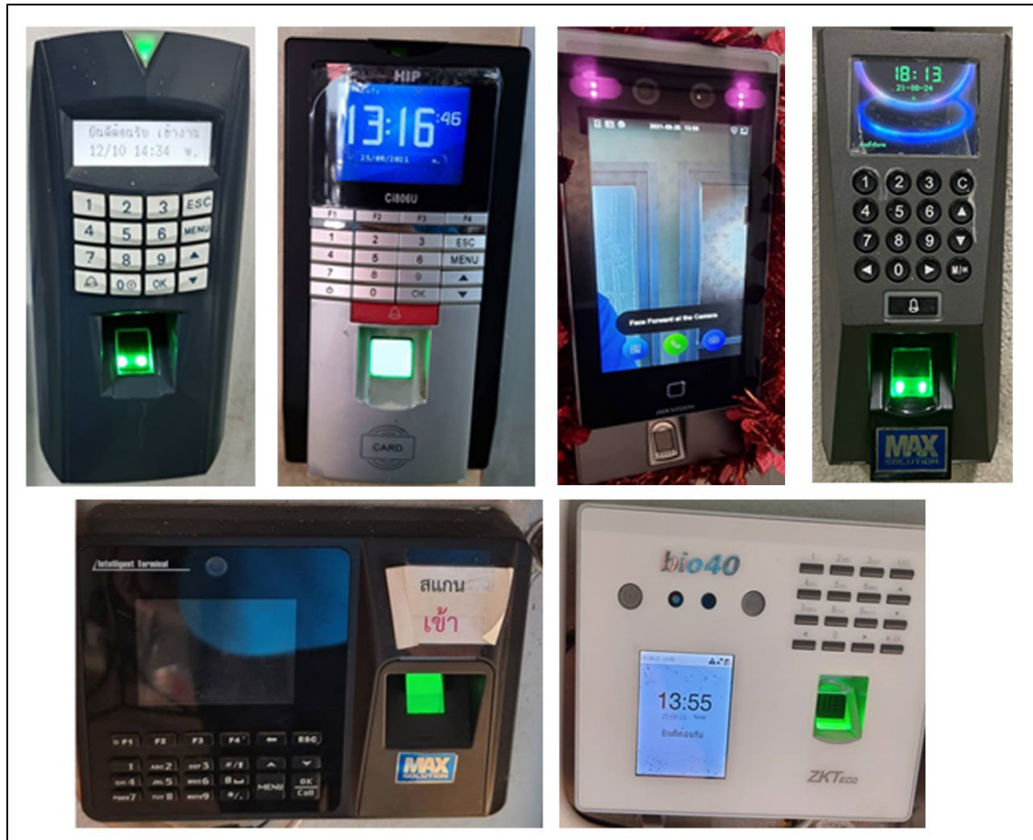
ภาพที่ 3.6-2 ภาพตัวอย่างระบบควบคุมการเข้า - ออก ของโรงงานไฟฟ้า
